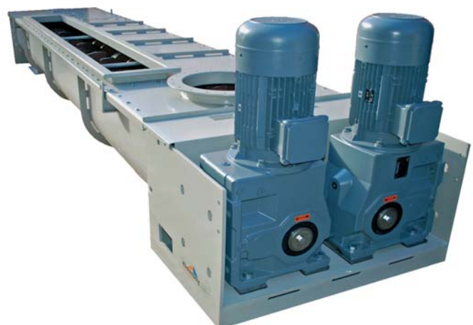
Twee assen aangedreven paddelmenger voor het mengen van vliegasslurry met gedroogd vliegass. Assen zijn separaat aangedreven. Paddels zijn vervaardigd uit gehardstaal en opgelast met vautid 100. Gemiddelde hardheid van 750 tot 1000 HV
