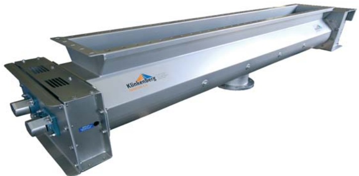
Twee assen aangedreven paddelmenger met brekerpennen voor het breken van agglomeraten die ontstaan tijdens het mengen van kleverige producten.
