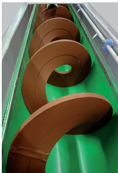
Asloos schroeftransport, huis uit RVS304 liner HDPE-1000 met sproei nozzels
