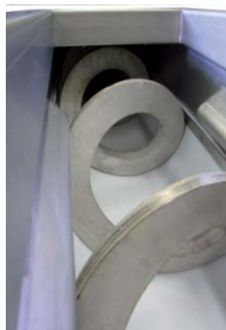
Asloos schroeftransport geheel vervaardigd uit RVS316L uitvoering met neerhouders
