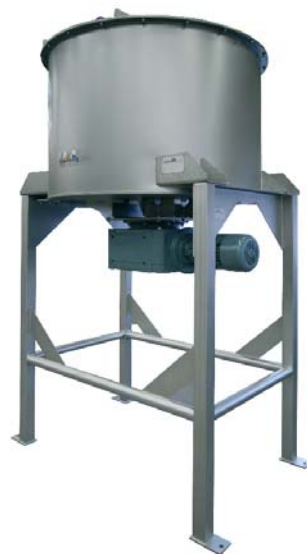
Unit t.b.v. uitdoseren van DDGS (Distillers dried grains with solubles), DGS (distillers' grains and solubles)
