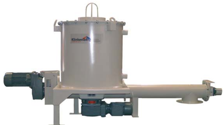
Agitatorunit met doseerschroef beladen door BigBag lossysteem
