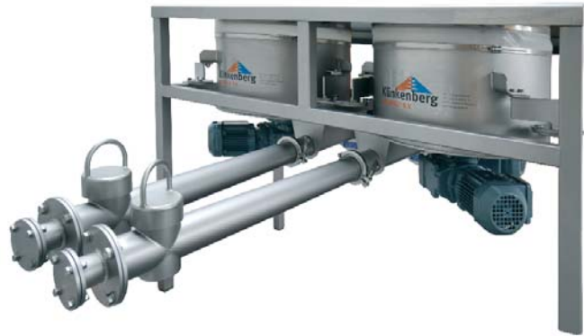
Gewogen doseersysteem met dubbele agitator en twee doseerschroeven uitgevoerd met opleg/snijtafel voor het snijden van 25 kg zakken
