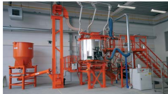
Laboratorium opstelling t.b.v. het produceren van zwavelbeton. Gewogendoseerschroef brengt zwavelpallets naar de elevator welke het opvoert naar de verticale
