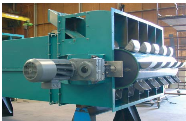
Vijfling elevator t.b.v. het gescheiden houden van kleurstoffen in fabricace processen in steenfabrieken
