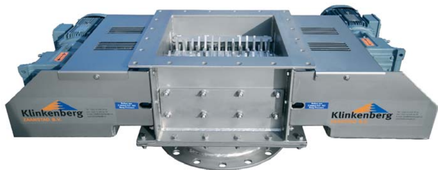
Twee assen aangedreven messenbreker voor het breken van zeer harde agglomeraten. Per as is een aandrijving voorzien. De messen zijn uitwisselbaar
