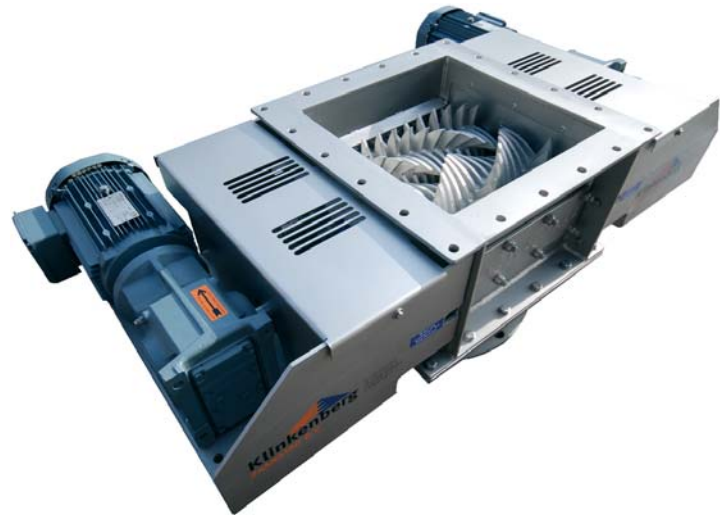
Twee assen aangedreven messenbreker voor het breken van zeer harde agglomeraten. Per as is een aandrijving voorzien.
