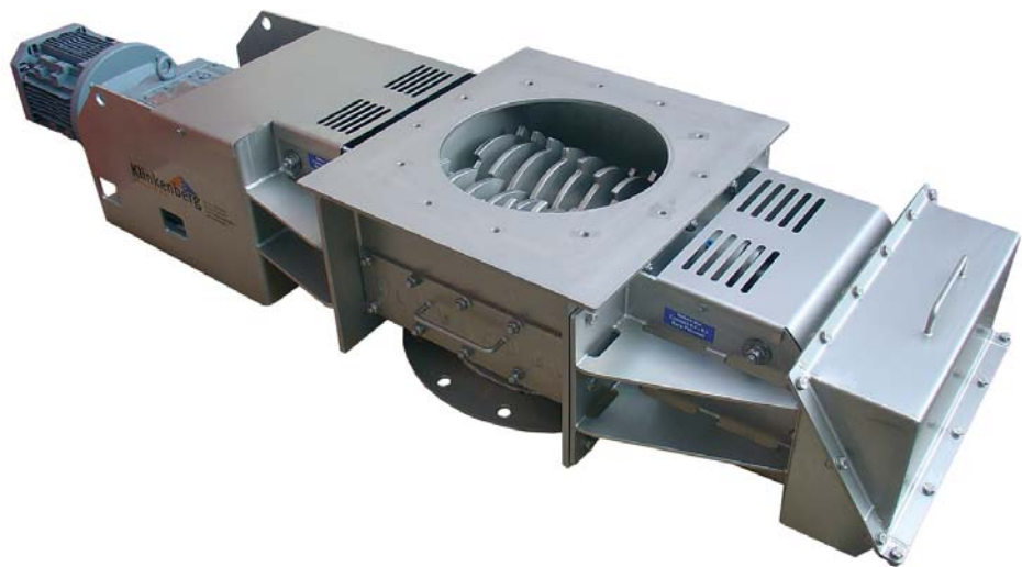
Klinkenberg HT Messenbreker tot 300 graden Celsius. Twee assen aangedreven door een enkele aandrijving. Watergekoelde astappen, afdichtingen en tandwielen.
